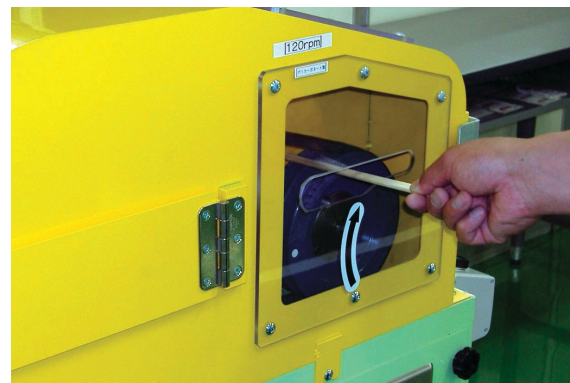
割り箸を使った「Vベルトへの巻き込まれ体験」装置
